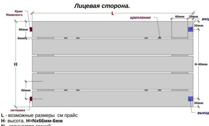
Крепление к полу через опоры на 4 отверстия (2 для каждой опоры) диаметром 8мм.
